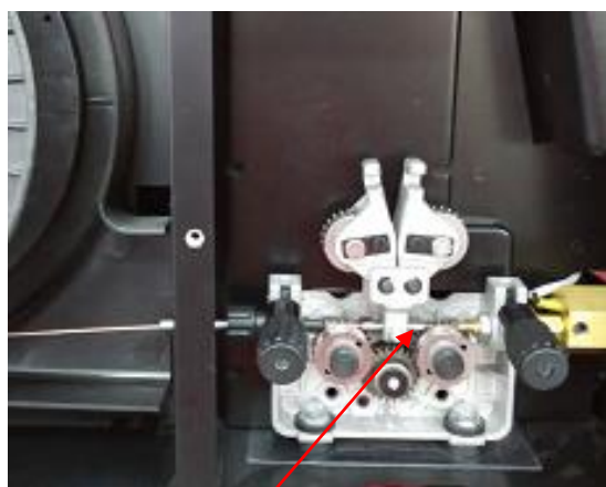
(5) Adagolja a huzalt a hajtógörgőn keresztül a huzaladagoló kimenő terelőcsővébe (kapiláris cső).
