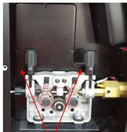
(6) Rögzítse a felső nyomógörgőt, és közepes erősségű nyomást alkalmazzon a feszítés állító gombon.
