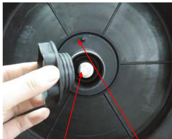
(2) Ügyeljen a feszítőrugó állítóra és a rögzítő tűre.
